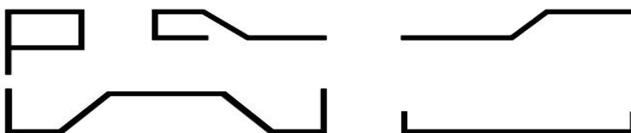
Рис. 5 Формы изгиба арматуры
